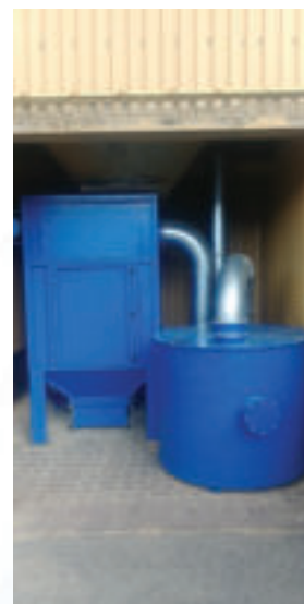
Odpylanie w procesie cięcia laserem tworzyw sztucznych
