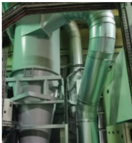
Cyklon - odzyskiwanie farby w procesie malowania proszkowego
